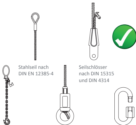
Anschlagkette; verkürzbar – mit Tragfähigkeitangabe (WLL) nach DIN EN 818-1
